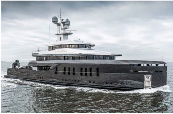
„Shinkai“: Den 55-Meter-Rumpf optimierte Vitruvius auf die Nutzung mit Kreiselstabilisator. Zu Tauchboot und Tender gesellt sich ein 4-x-4-Vehikel.
